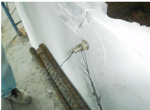
ภาพ ข. ภาพทดสอบการยึดฟูกเหล็กจริง
